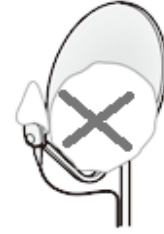
アンテナに雪が積もっている
