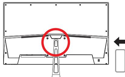
モニター表面が傷つかないよう平らな場所にタオルなどを敷き、その上に背面を上にした状態でモニターを置きます。スタンド上部をモニターの取付け部にしっかりと合わせ、二つのネジ穴をネジ(小)で固定します。
