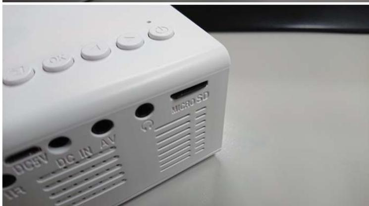
取り外す時は、スイッチのようにマイクロSDカードを押し込むとカチッと音がしてマイクロSDカードが取り出せるようになります。
