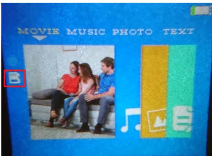
マイクロSDカードを認識すると、画面の赤枠の部分にアイコンが表示されます。取り外すとアイコンは消えます。
