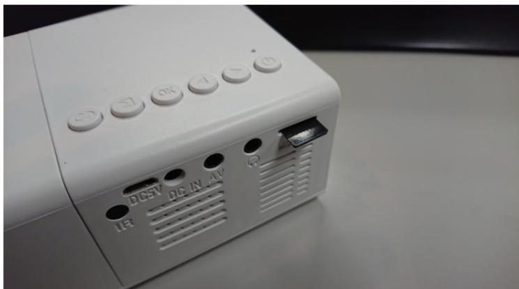
本体⑫のマイクロSDカードスロットにカードを挿入できます。マイクロSDカードの端子が上側になるように挿入します。奥までしっかり挿入し、カチッと音になるまで差し込んでください。
